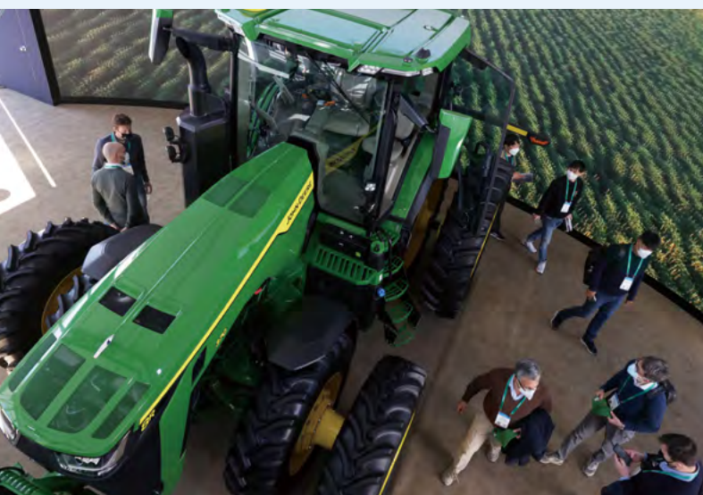
완전 자율주행 트랙터 세계 최대의 농기계 제조사 중 하나인 존디어에서 내놓은 완전 자율주행 트랙터는 새 기계를 살 필요 없이 기존 모델에 2개의 모듈을 달면 자율주행 트랙터로 바뀐다.
